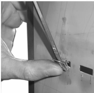
Abbildung 5: Einstecken des Snap-On-Clip
