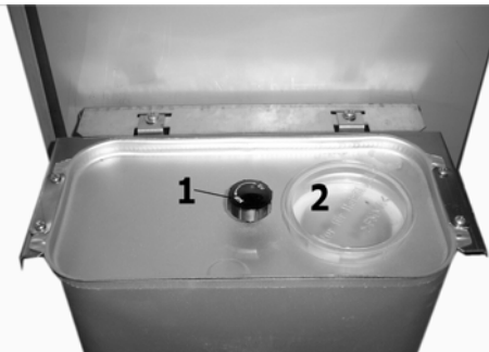
Abbildung 22: Öltank 1 Tankabsperrventil 2 Tanksteckdeckel
